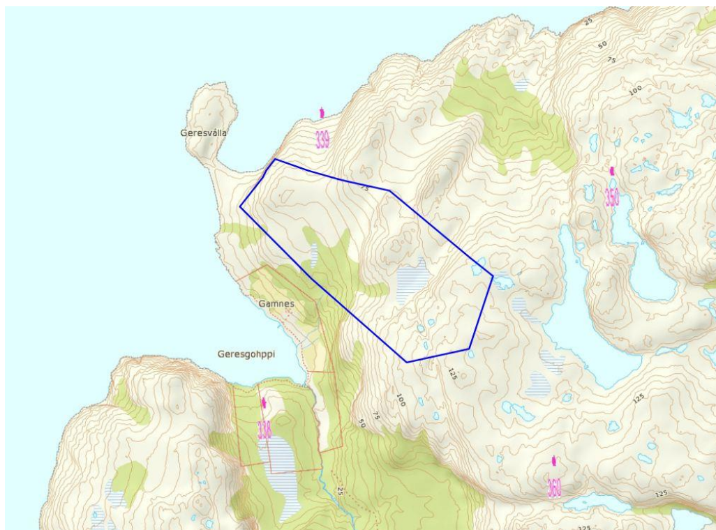
Figur 2: Nedbørsfelt til kavernene basert på topografi markert med blått polygon.
