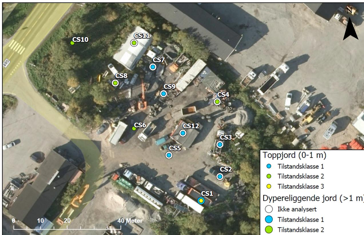
Figur 4-1: Plassering av prøvepunkt med angivelse av høyeste tilstandsklasse uavhengig av type miljøgift. Punkter markert i hvitt er ikke analysert.
