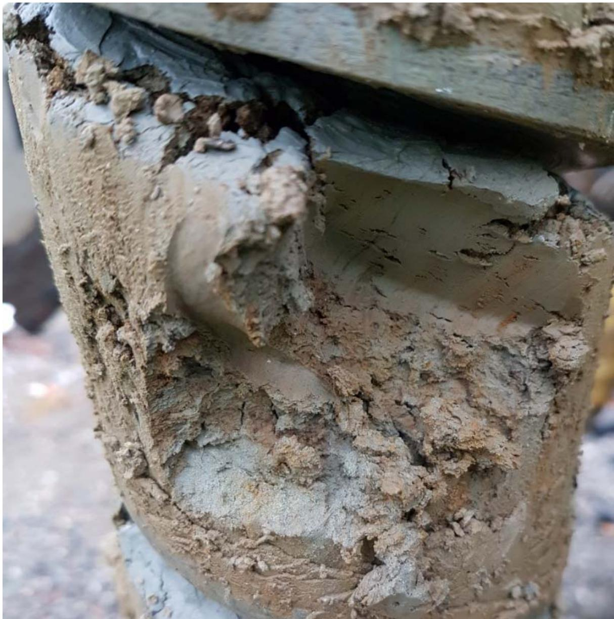
Figur 3: Skovlprøve fra prøvepunkt CS11 (0-1 m).
