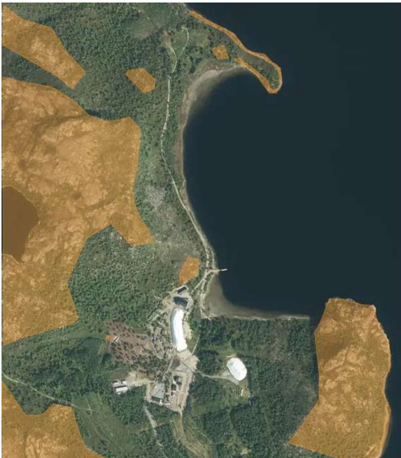
Figur 13: Flyfoto over området fra 2019, berg i dagen samt større fjellpartier er markert med oransje skravur [norgebilder.no]
